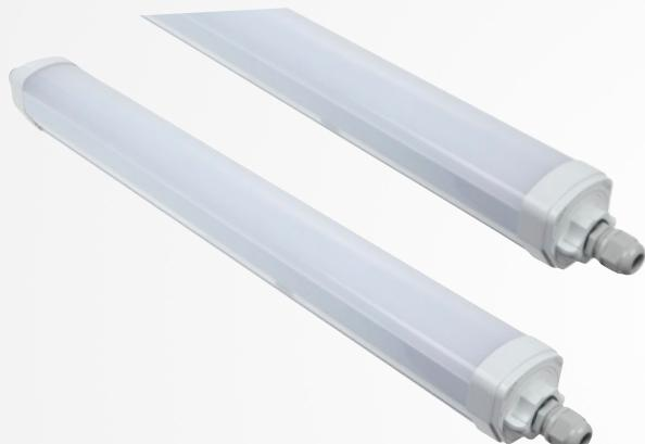
Luminaire design et solide en polycarbonate avec câblage traversant pour des installations en séries. Il est équipé de part et d'autre de trappe à glissière avec connecteur à levier pour un câblage facilité et rapide.
