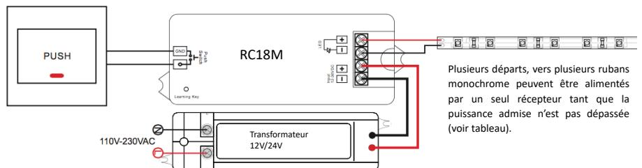
Le récepteur **RC18M** s'alimente en 12V ou 24V DC
