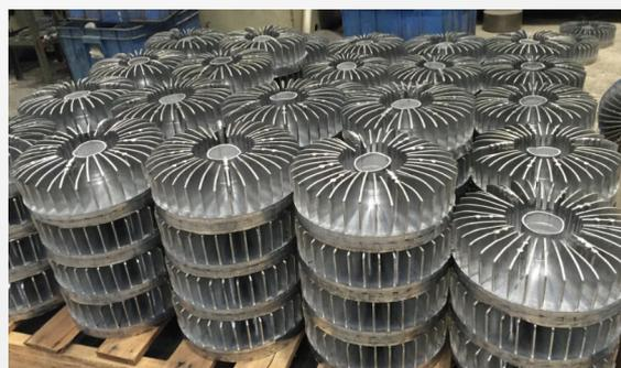
Dissipateur thermique avant/après pressage
